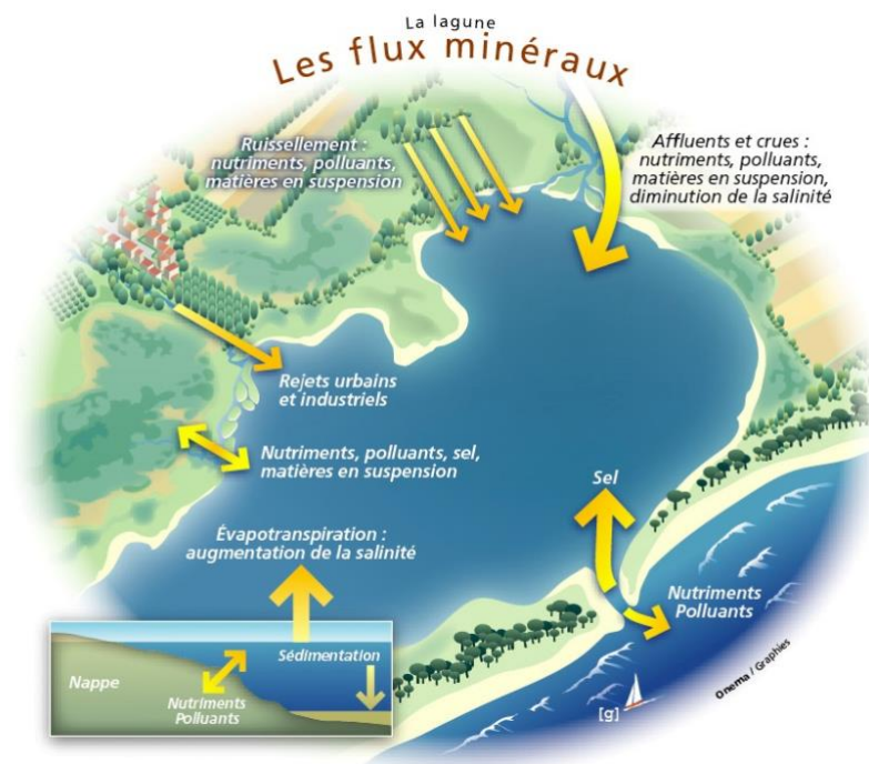
Figure 6. Schéma des principaux flux sédimentaires et minéraux existants au niveau des lagunes côtières (Eau France Service Public 2015).
